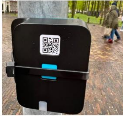
4G zendmodem en druktesensor met QR code
