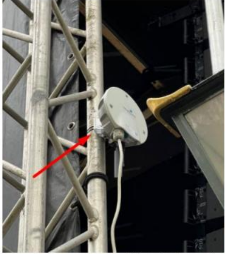
4G zendmodem en druktesensor met QR code
