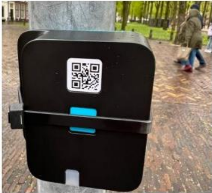
4G zendmodem en druktensensor met QR code
