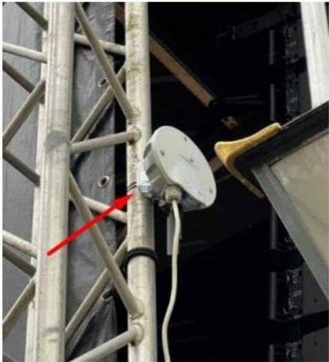
4G zendmodem en druktensensor met QR code
